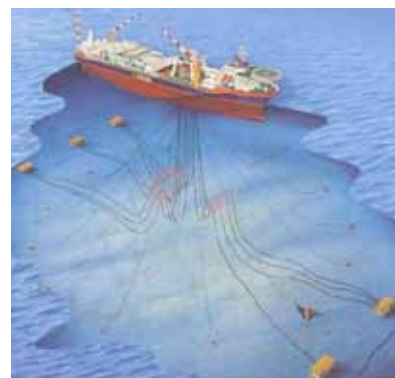
Flytende marine konstruksjoner som brukes i olje/gass-utvinningen, kan være enten spesialskip som ovenfor, eller flytende plattformer av ulike typer, se sidene 10-14/15. Der kan du lese mer om disse.
